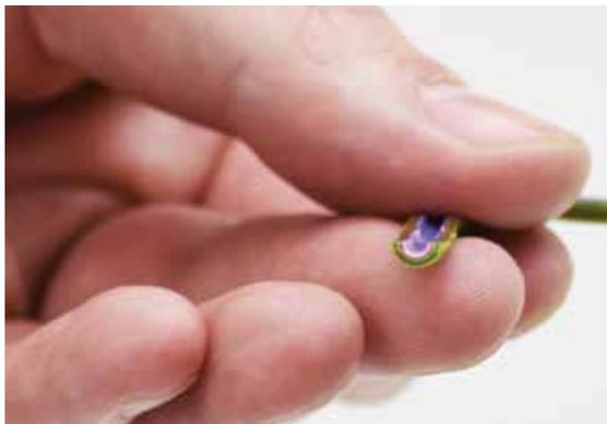
Le modèle de lésion imprimé en 3D de CSI, qui utilise des matériaux et des multi-matériaux PolyJet en plusieurs couleurs.
