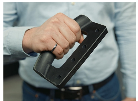
La poignée imprimée en 3D avec le matériau Dura56.
